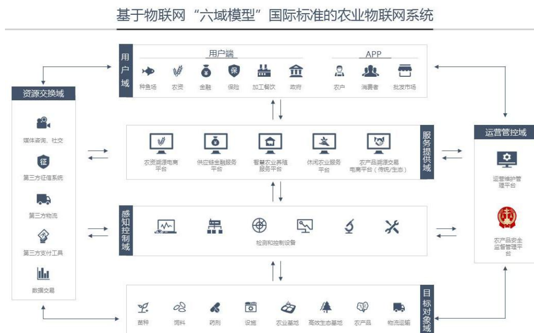
图一 基于物联网六域模型的农业物联网系统架构（例）
